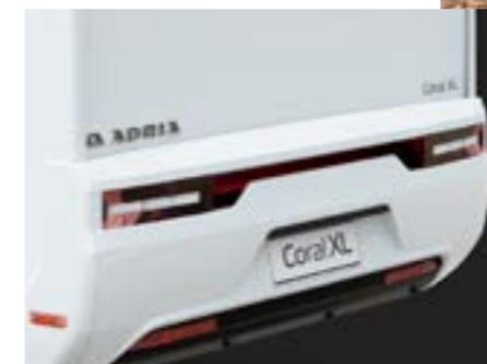
Construction de la carrosserie en Adria Complex pour une qualité durable et fiable ; avec une capucine élégante et bien intégrée au véhicule ; nouvelle paroi arrière avec diffuseur de flux d'air et feux LED Hella ; nouveau double plancher, plancher à un seul niveau partout et rangement supplémentaire ; large porte d'entrée de 650 mm avec rangement intégré.
