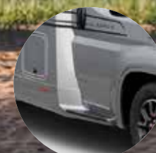
OP DE VORM VAN DE CAMPER AFGESTEMDE ZIJSKIRTS (EN OPTIONELE CABINE OPSTAP)
