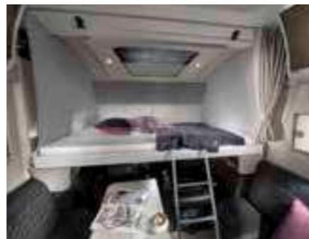
**Cama desplegable frontal:** perfectamente integrada con fácil acceso, y buena iluminación y ventilación. Cama de 1 600 x 2 000 mm, de estructura ligera, con buena altura en posición vertical cuando no se utiliza.
