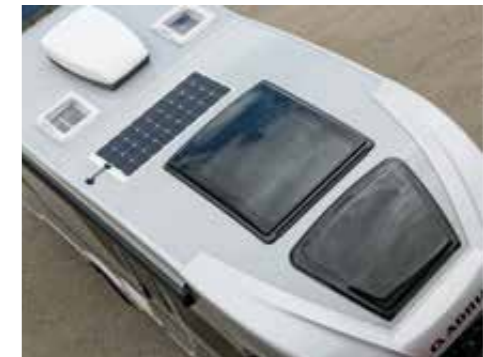
PANNEAU SOLAIRE CLIMATISATION CELLULE
